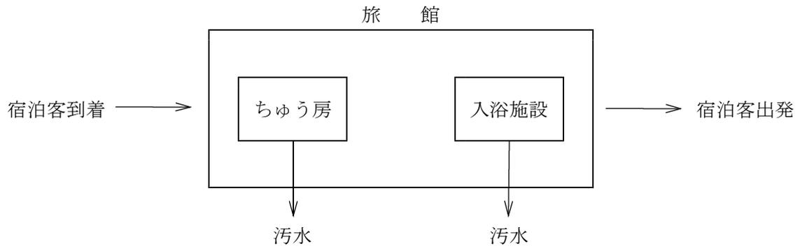
第3図 汚水等の処理の系統
