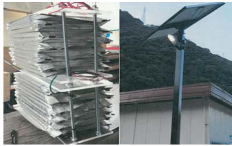
2-(2) 太陽光発電パネルと「ゆず残渣蓄電池」を組み合わせた照明機器
